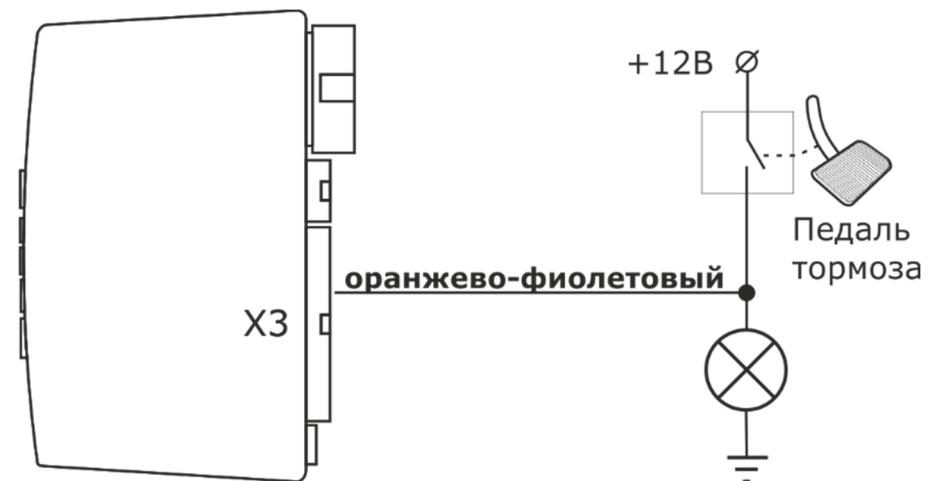
На автомобиле с ручной трансмиссией его необходимо подключить к стояночному тормозу, установив диод в разрыв штатного провода стояночного тормоза. См. рисунок ниже.
