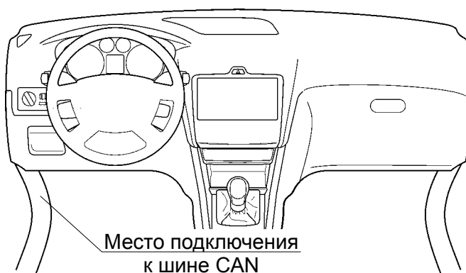
Рисунок 2. Рекомендуемое место подключения к шине CAN.
